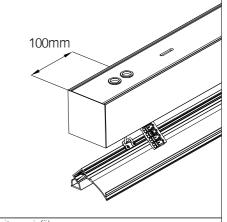
3. Leitungseinführung. Cable entry point.
